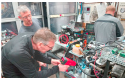
Modul 4: Einstellarbeiten Zündung mit Stroboskoplampe
